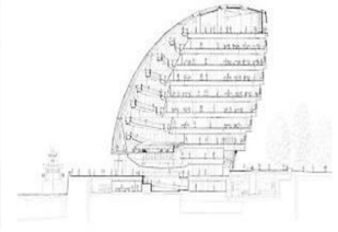
شكل (٢٦) قطاع يوضح بروز الأدوار العليا عن السفلى قطاع يوضح بروز الأدوار العليا عن السفلى ٤٢ .
