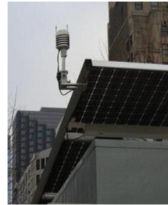
شكل (٤٢) مجسات حرارة خارجية للمنزل ٥٥
